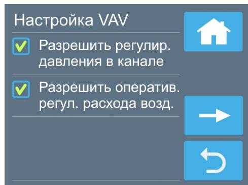
Если этот селектор установлен, то при нажатии на поле «Скорость вентилятора» на основном экране откроется страница регулировки расхода воздуха. Для изменения расхода выберите нужную зону, после чего с помощью вертикального слайдера (ползунка) установите требуемый расход от 0 до 100% (недоступно при управлении расходом только от ручного регулятора или датчика). Если предыдущий селектор также активен, то будет доступна регулировка давления (от 1 до 8 ступени).
